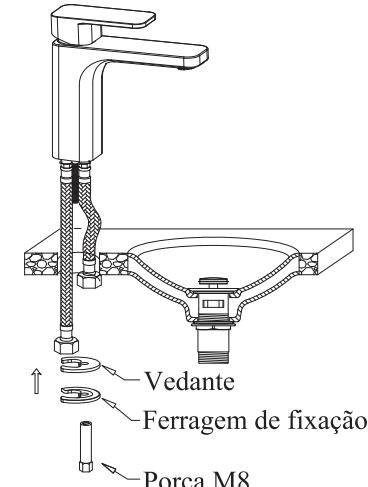
**2.** Passar os flexíveis através do orifício preparado para o efeito, no móvel ou no lavatório/bidé. Por baixo, posicionar o vedante, a ferragem de fixação e a porca hexagonal.
