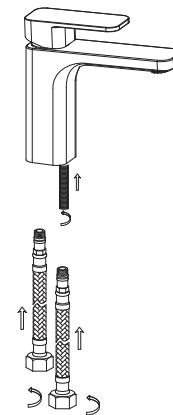
**1.** Fixar a haste rosada M8 no furo rosulado da torneira. Enroscar completamente os dois flexíveis à torneira, manualmente.
