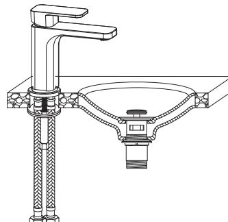
**3.** Ajustar a ferragem de fixação, certificando-se de que a torneira monocomando está centrada com o furo. Apertar a porca hexagonal até eliminar a folga entre os elementos de fixação e o móvel ou lavatório/bidé, mas de forma a permitir o ajuste da orientação da torneira. Orientar correctamente a saída de água da torneira. Apertar a porca hexagonal até a torneira estar suficientemente firme.
