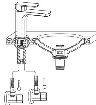
**4.** Ligar os dois flexíveis aos respetivos circuitos de água: esquerdo para a água quente e direito para a água fria. Com a torneira fechada, abrir as torneiras de segurança e verificar a existência de fugas na torneira e nas juntas.
